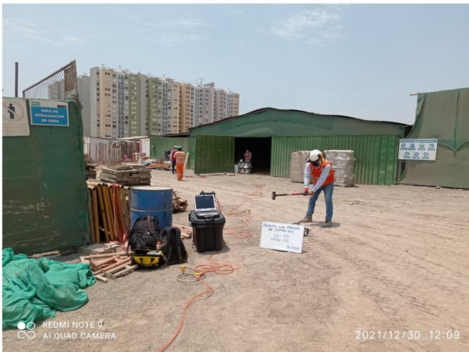
**Foto N° 4.-** Disposición de las conexiones, vista del equipo sísmico PASI y golpe entre los geófonos 12 y 13 para la adquisición de datos de la línea LS-02
