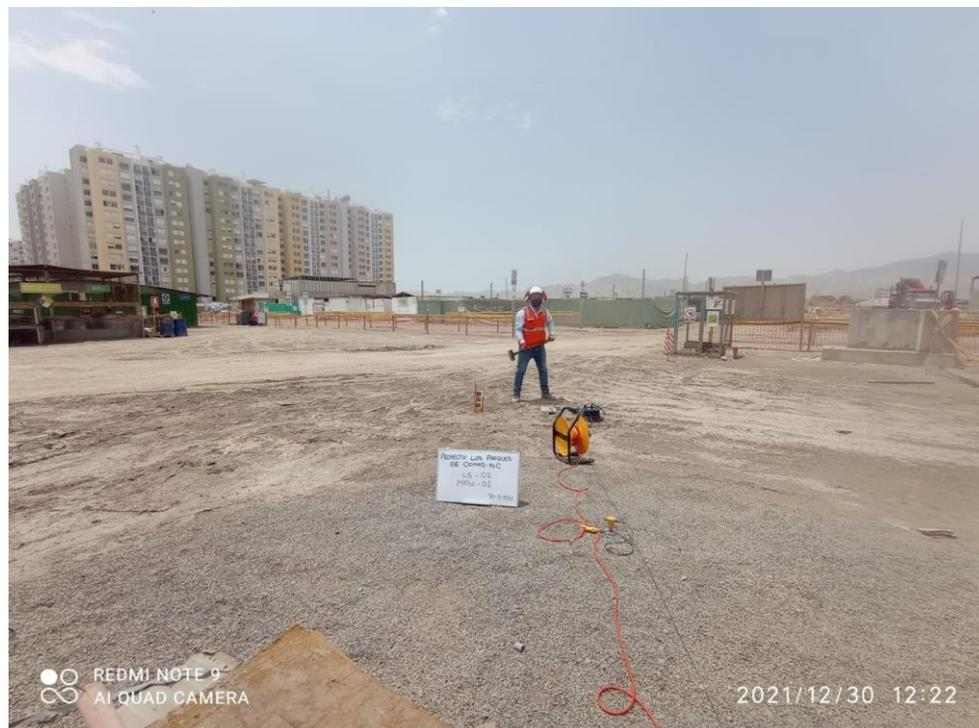
Foto N° 2.- Vista de los cables sísmicos instalados para la adquisición de datos de la línea LS-02
