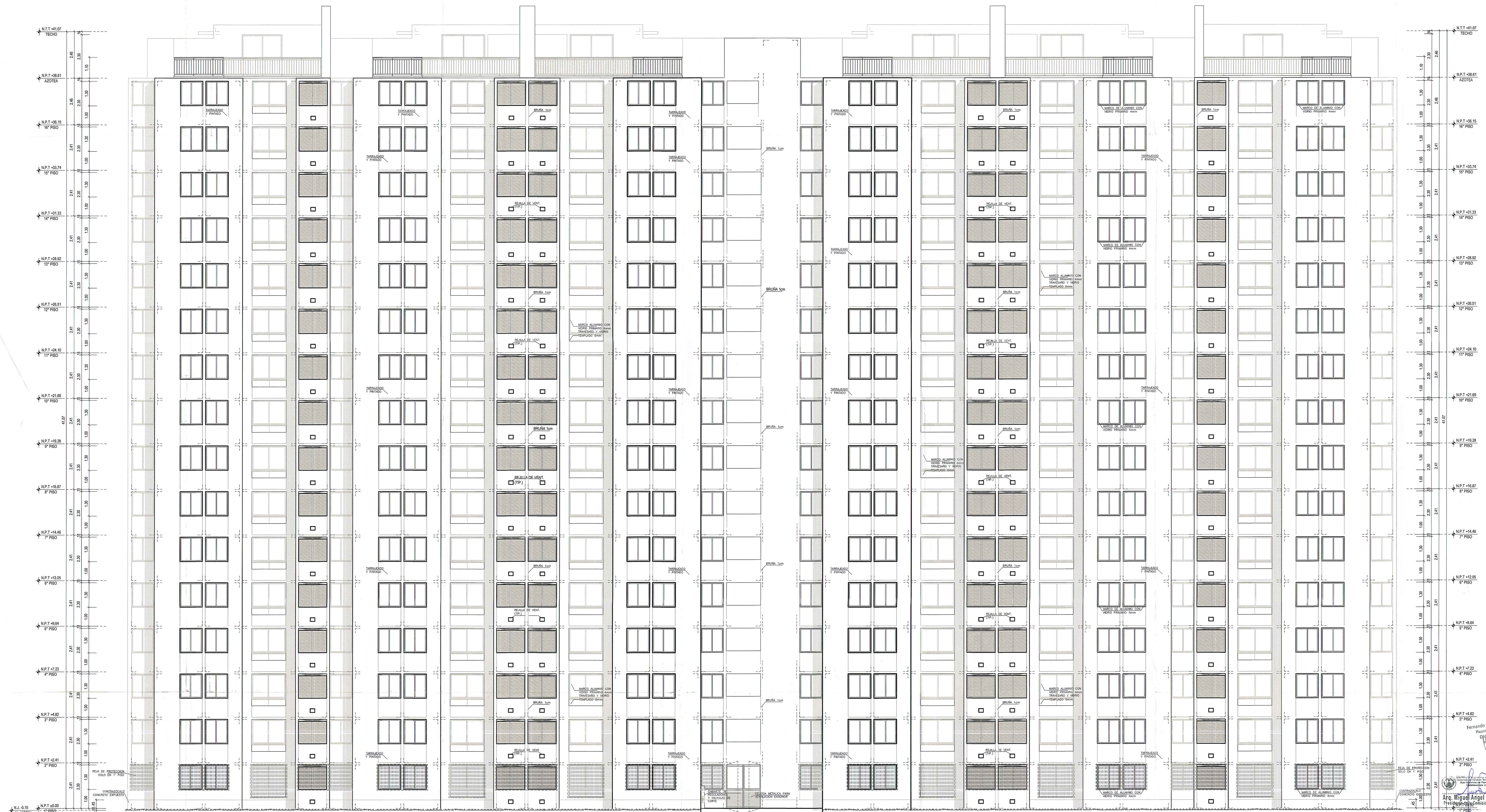
ELEVACION 1 - PRINCIPAL Esc. 1/75 EN CORTES Y ELEVACIONES NIVELES DE PISOS SUPERIORES CONSIDERAN NPT DE 1° PISO +0.30
